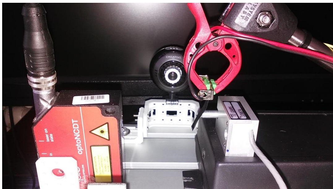
Rysunek 8. Stanowisko do pomiaru siły i przemieszczenia (wyznaczenie modułu Younga)
