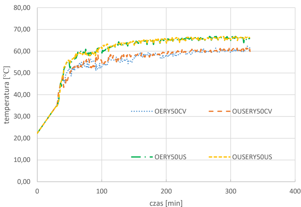
Rysunek 75. Krzywe temperaturowe w procesie suszenia dla próbek odwadnianych w roztworze erytrytolu
