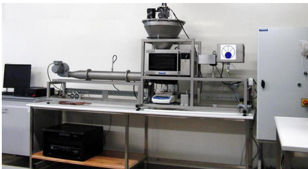
Rysunek 33. a). Schemat suszarki hybrydowej: 1 - pompa powietrza; 2 - komora suszarki; 3 - konwerter; 4 – generator mikrofal; 5 - waga; 6 - komputer; 7 – generator ultradźwięków; b) stanowisko suszarki hybrydowej [157]
