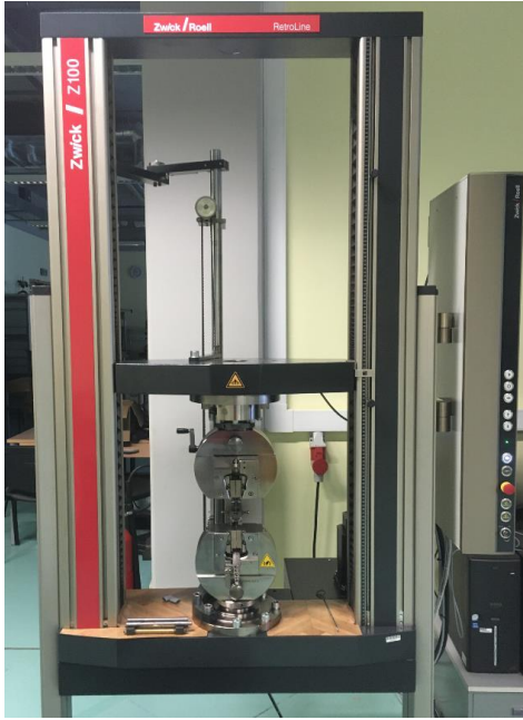
Fig. 7.4. Zwick Z100 universal testing machine
