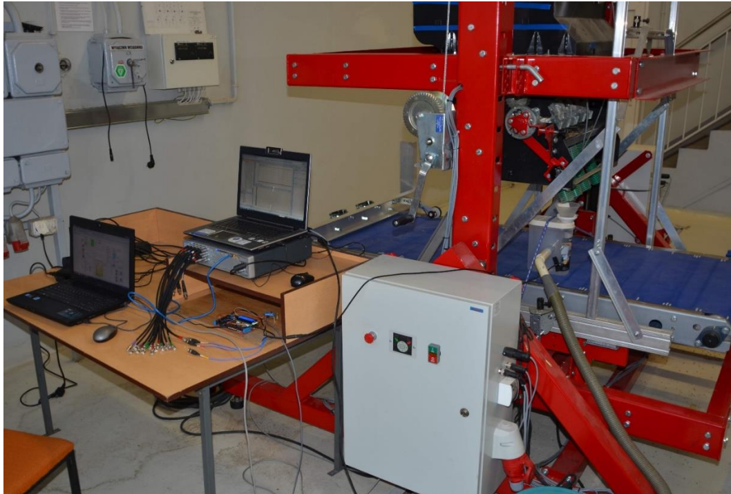
Rys. 5.13 Stanowisko badawcze w konfiguracji do rejestracji wysianych nasion czujnikiem piezoelektrycznym
