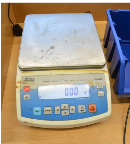
Rys. 5.20. Stanowisko badawcze masy 1000 nasion
