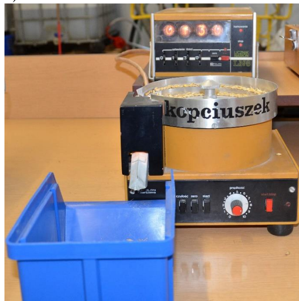
Rys. 5.20. Stanowisko badawcze masy 1000 nasion
