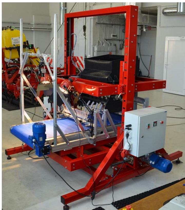
Rys. 5.12 Stanowisko badawcze w konfiguracji do optycznej rejestracji wysianych nasion
