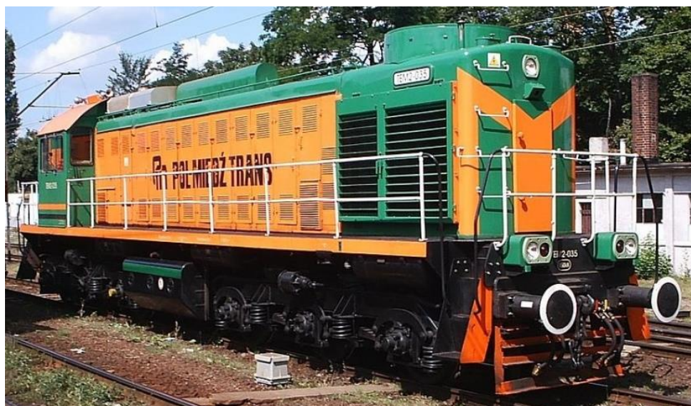
Rys. 5.10. Widok ogólny lokomotywy serii TEM2-035 z silnikiem 12V4000R41 [114]
