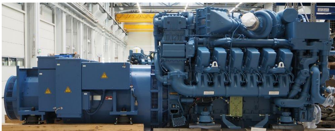
Rys. 7.6. Widok na zespół prądnicowy z silnikiem typu MTU 12V4000R84 (dla modernizowanej lokomotywy 19D) [53]
