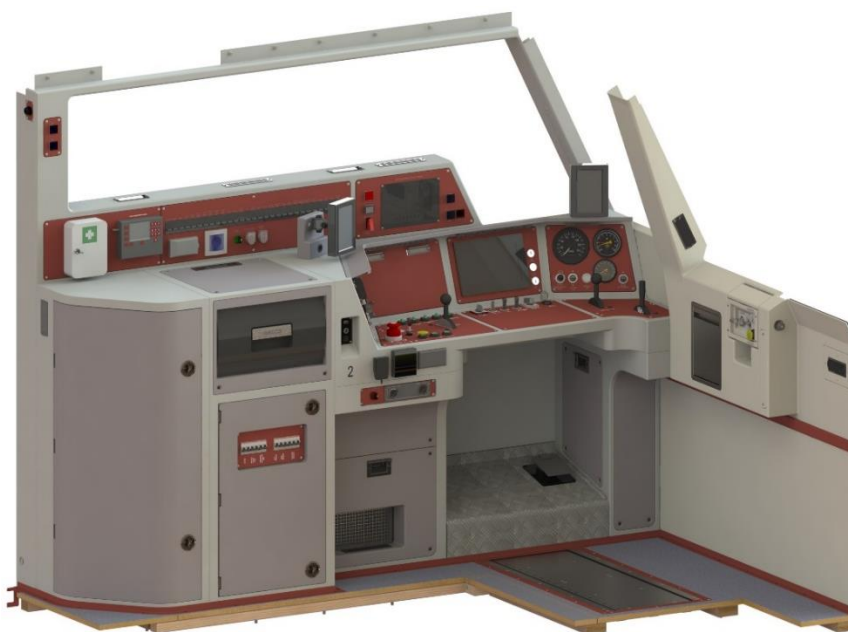
Rys. 7.13. Pulpit i panele nad pulpitem od strony przedziału elektryczno-pneumatycznego [16]
