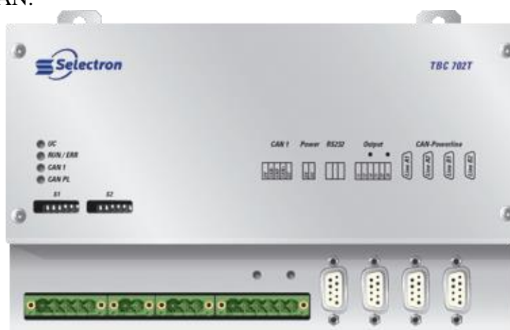
Rys. 6.19. Widok modułu sprzęgu magistrali pociągu TBC 702-T [35]
