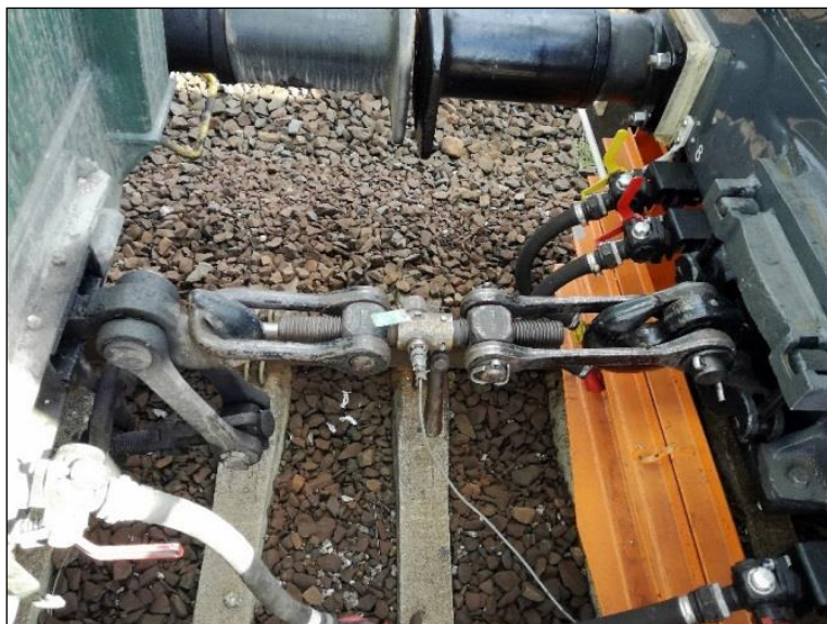
Rys. 8.2. Widok sprzęgu pomiarowego na połączeniu lokomotywy z pociągiem towarowym [7]
