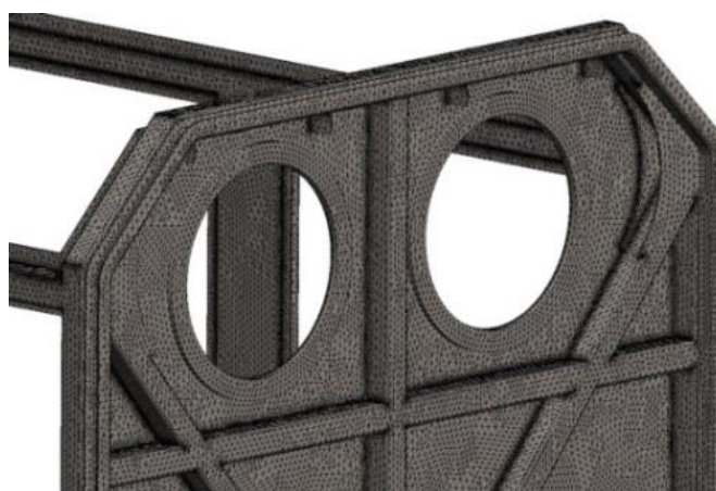
Rys. 6.28. Podział modelu obliczeniowego kontenera 0306 na elementy skończone [5]
