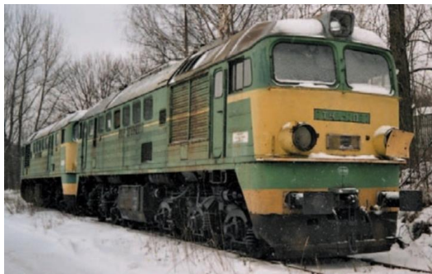
Rys. 5.1. Widok ogólny lokomotywy typu ST44, przed modernizacją [105]
