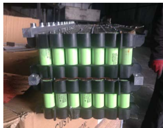
Rys. 11.8. Ogniwa połączone w sekcje jako elementy składowe akumulatorów.
