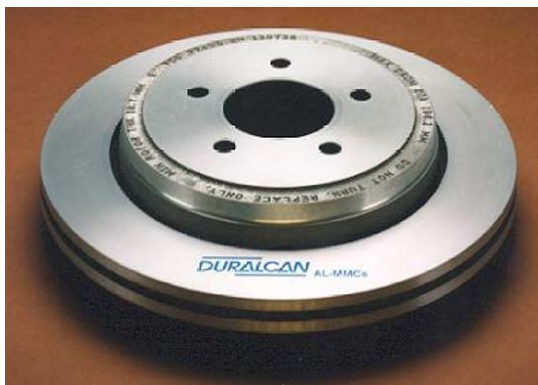
Rys. 16.2. Tarcza kompozytowa MMC wykonana przez DURALCAN do samochodu Chrysler Prowler
