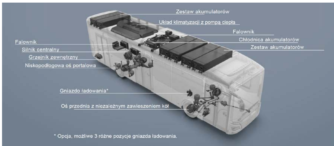
Rys. 11.12. Rozmieszczenie komponentów w autobusie elektrycznym
