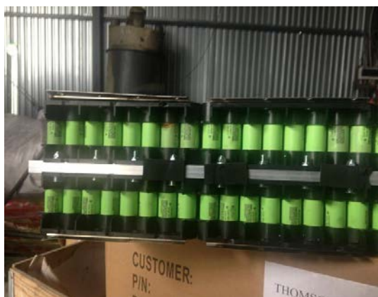
Rys. 11.8. Ogniwa połączone w sekcje jako elementy składowe akumulatorów.
