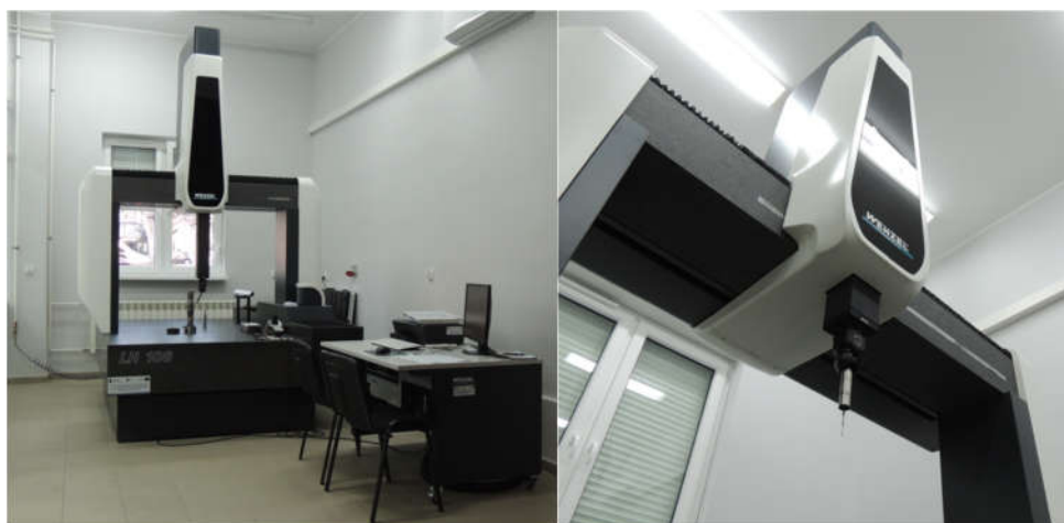
Rys. 33 Stanowisko pomiarowe maszyny współrzędnościowej [117]
