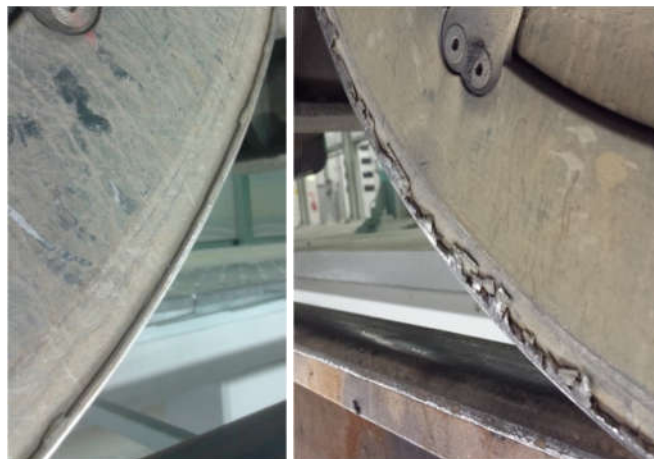
Rys. 13 Odształcenia plastyczne obręczy kół tramwajowych [43]
