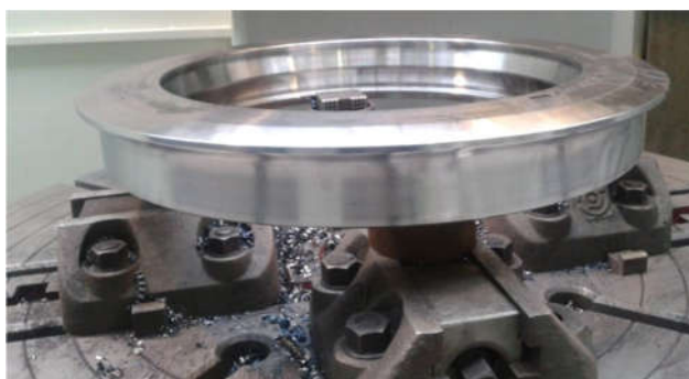
Rys. 77 Obręcz tramwajowa zamocowania czteropunktowo w tokarce karuzelowej LV1600S [128]
