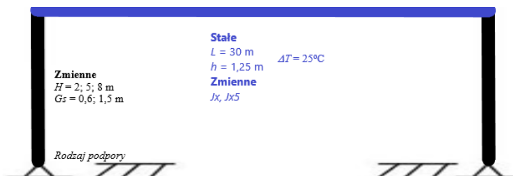
Rys. 9.5 Schemat Zintegrowanych konstrukcji ramowych o stałych L = 30 m, h = 1,25 m, ( \Delta T = 25^\circ\text{C} ) i zmiennych H , G_s , J_x , J_{x5} oraz podporach przegubowo-nieprzesuwnych lub sztywno-zamocowanych
