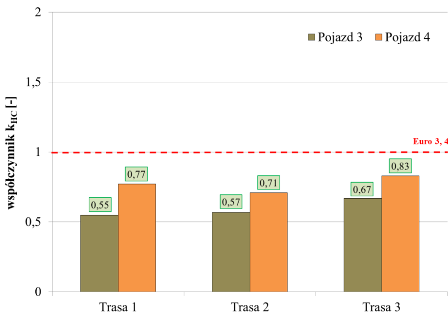
Rys. 6.50. Wartości współczynnika k_{HC} wyznaczone na podstawie pomiarów w warunkach drogowych i wartości dopuszczalnych emisji spalin Euro 3,4
