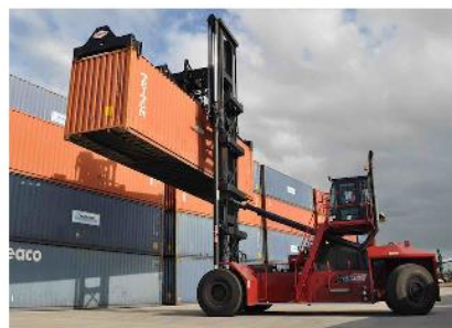
wóz masztowy do przeładunku pełnych kontenerów
