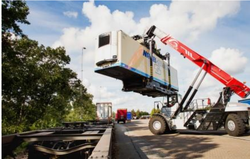
Rys. 3.11. Platforma z naczepą podczas załadunku na wagon koszowy systemu NiKRASA [46]
