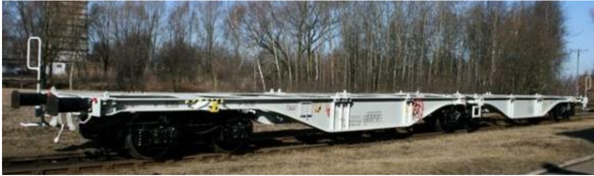
Rys. 3.2. Uniwersalny 6-osiowy przegubowy wagon platforma 80' typu 629Z serii Sggrss-K [64]
