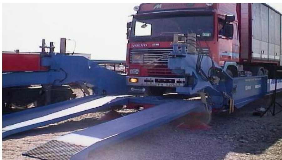
Rys. 3.26. Odchylona platforma wagonu Flexiwaggon podczas wyładunku [47]
