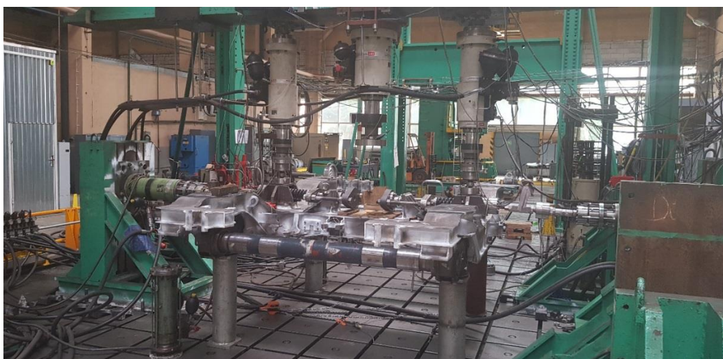
Rys. 6.41. Rama wózka dwunapędowego lekkiego pojazdu szynowego na stanowisku badawczym
