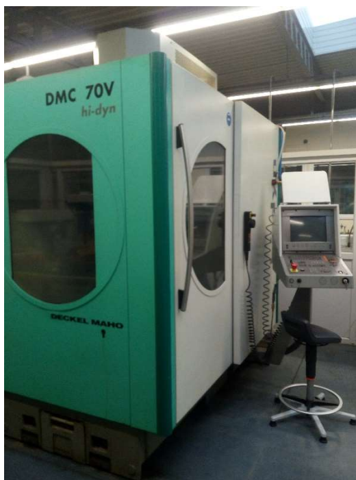
Rys. 3.1. Centrum obróbkowe firmy DECKEL MAHO model DMC 70V hi-dyn
