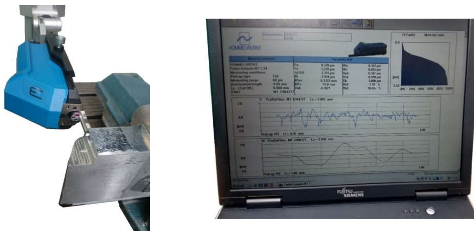
Rys. 3.8. Profilografometr firmy Hommelwerke T500 wraz z oprogramowaniem Turbo DataWin-NT 1.34
