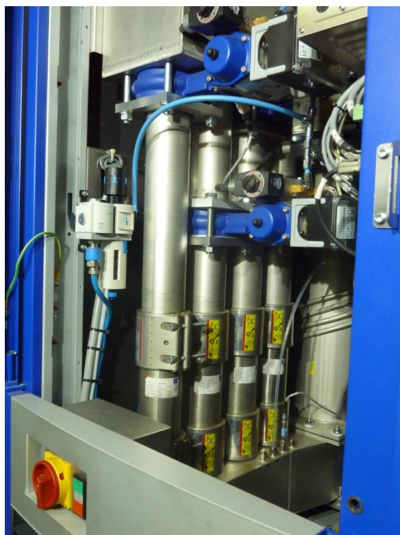
Rys. 2.4. Zestaw zwężek Venturiego w układzie poboru spalin CVS i60 stosowanym w ITS
