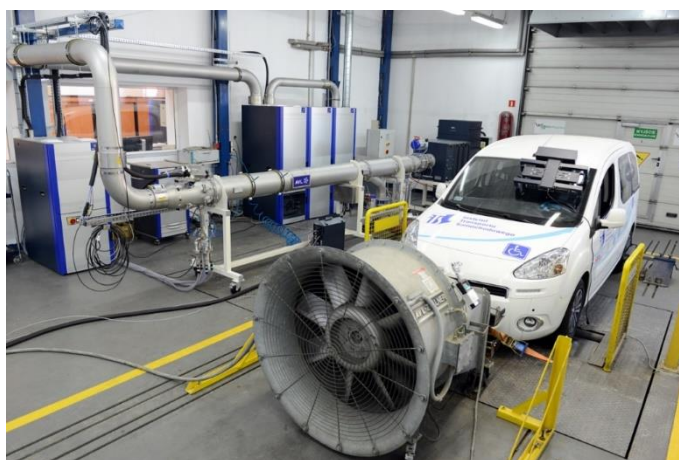
Rys. 4.8. Zdjęcie hamowni podwoziowej z układem do pomiaru emisji zanieczyszczeń
