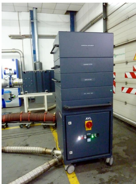
Rys. 2.9. Urządzenie do mieszania spalin z powietrzem rozcieńczającym, wyposażone w trójstopniowe filtry oczyszczające i układ do podgrzewania powietrza rozcieńczającego zastosowane w układzie poboru spalin CVS i60 będącym na wyposażeniu ITS
