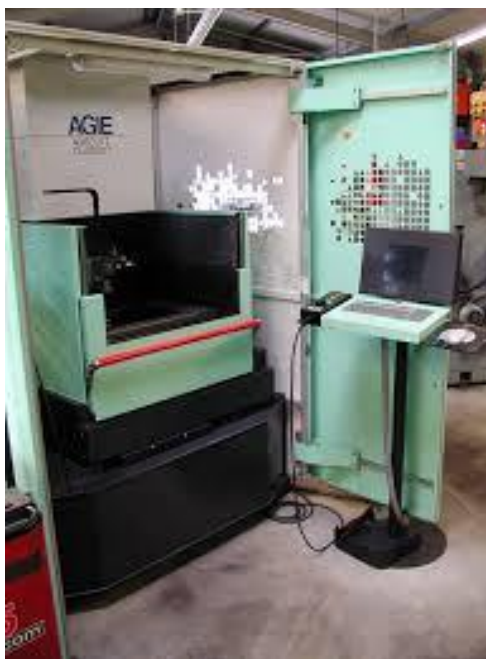
Rys. 4.3. Zdjęcie elektrodrażarki Agiecut Classic 2 (źródło własne)
