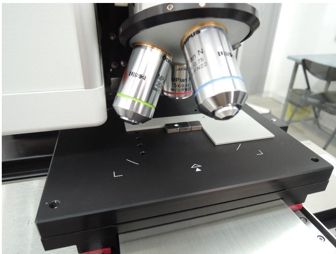
Rys. 5.1. Płytki skrawające podczas pomiaru twardości (źródło własne)
