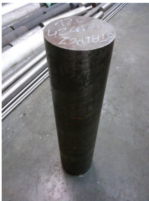
Rys. 4.9. Wałek z materiału obrabianego stosowany do dalszych badań eksploatacyjnych (źródło własne)
