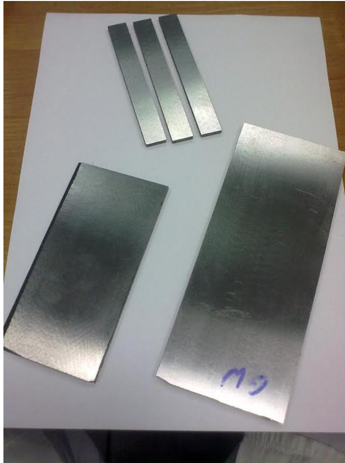
Rys. 4.4. Płaskowniki z konwencjonalnej stali szybko tnącej HS6-5-2 i spiekanej stali szybko tnącej PM6-5-2 po operacji szlifowania zgrubnego (źródło własne)
