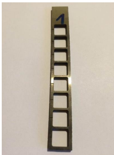
Rys. 4.5. Płaskownik ze spiekanej stali szybko tnącej PM6-5-2 po wycięciu z niego płytek skrawających (źródło własne)
