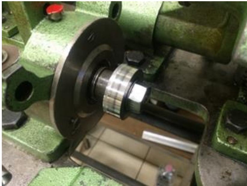
Rys. 5.17. Zdjęcie z badania współczynnika tarcia na maszynie Amsler (źródło własne)
