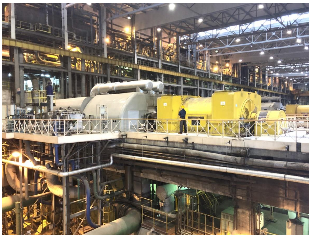
Rysunek 4.1 – Turbozespół 120 MW widok 1
